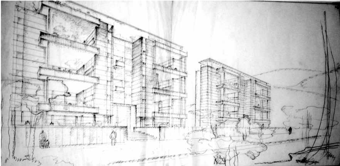
Figura 7. “Edificios residenciales”. Vista en perspectiva. Técnica: estilógrafo sobre pergamino. Fragmentación del bloque y la configuración del volumen mediante el apilamiento de espacios tipo casa
