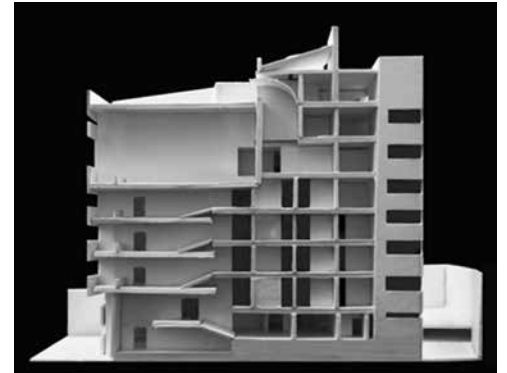
Figura 6. Maqueta analítica. Seccionando el proyecto, lo que permite al estudiante entender y relacionar los planos con la solución espacial interna, y su correspondencia con el emplazamiento
