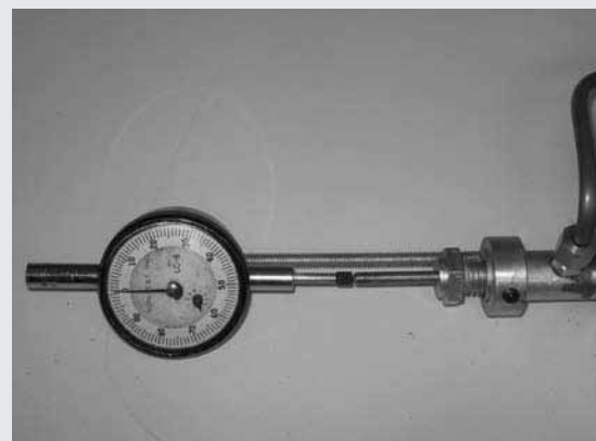
FIGURA 6. CONSOLIDÓMETRO ROWE CON ANILLO MODIFICADO: PISTÓN Y DEFORMÍMETRO
