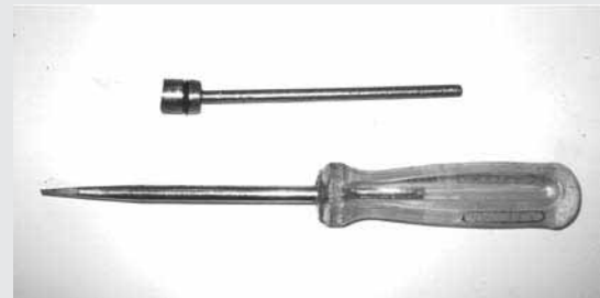
FIGURA 5. CONSOLIDÓMETRO ROWE CON ANILLO MODIFICADO: PISTÓN
