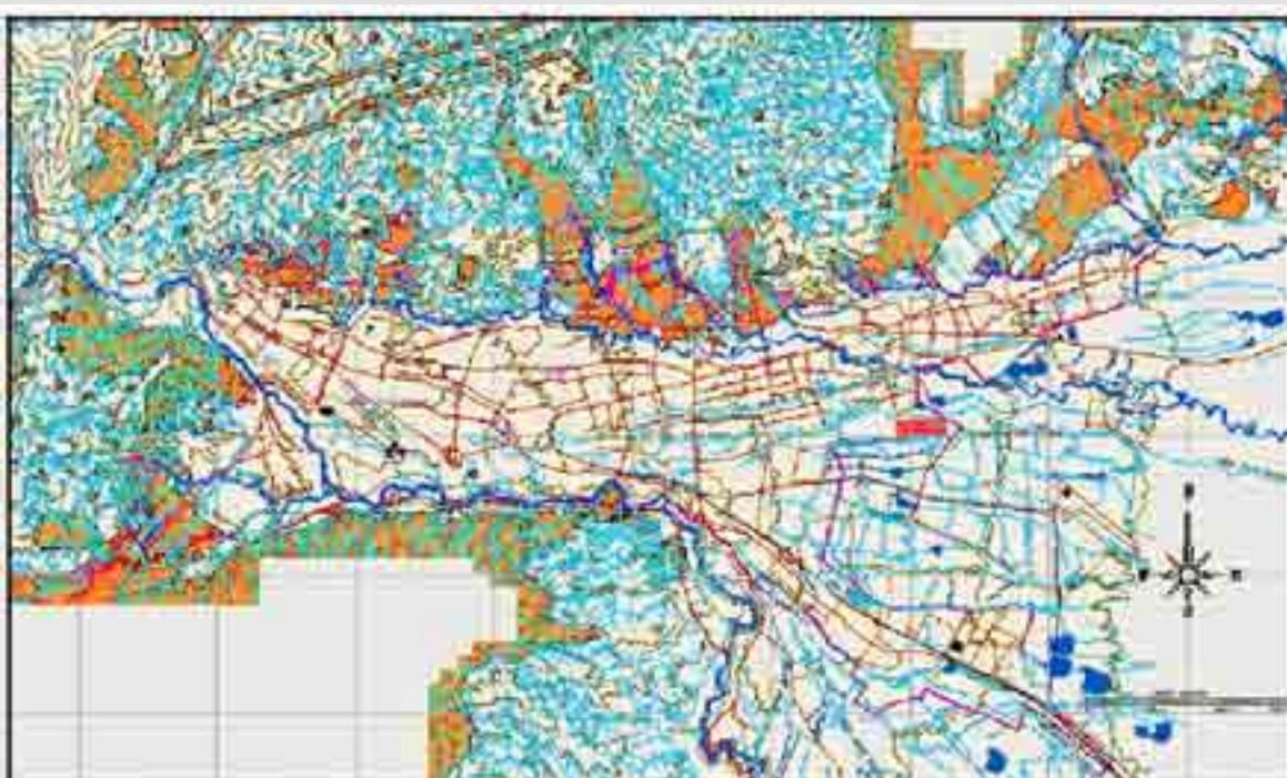
FIGURA 5. MAPA DE ZONAS CON POSIBLE PRESENCIA DE FENÓMENOS DE REMOCIÓN EN MASA (MODIFICADO DE BELTRÁN Y CASTIBLANCO, 2001) (SIN ESCALA).
