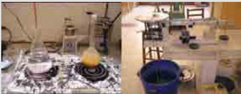
FIGURA 4. PESO ESPECÍFICO DE LA ARENA DE PEÑA Y DEL AGREGADO PÉTREO GRUESO.
