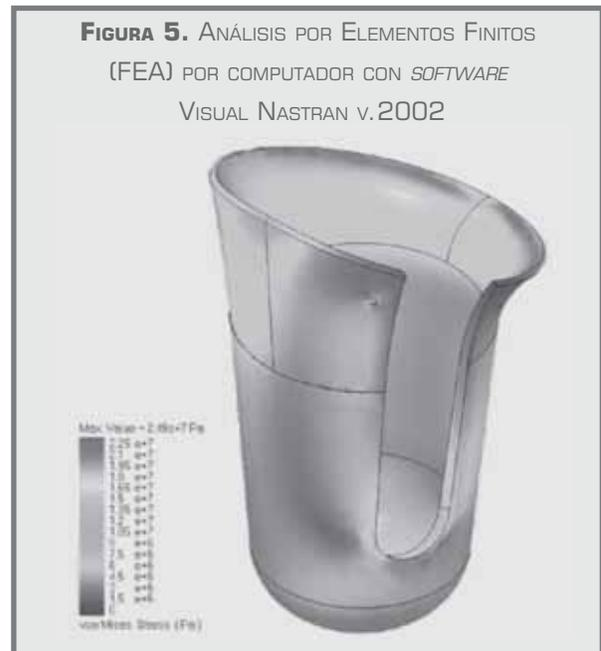
El diseño del encaje se hizo teniendo en cuenta que éste debe contener al muñón; para distribuir las fuerzas de carga del peso sobre estructuras anatómicas que puedan tolerar la presión sobre un hueso plano. El encaje debe ser ligero de peso y resistente, permitiendo que el usuario ejecute actividades de la vida cotidiana con cierta facilidad; razón por la cual, se hizo el análisis de ingeniería por elementos finitos (FEA) en *software* (Vera y Arias, 2003), como se muestra en la Figura 5.
