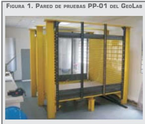
La PP-01 tiene una gran flexibilidad para la constitución de modelos gracias a su diseño modular, en un futuro cercano será dotada con seudomecanismos de aplicación de cargas verticales sobre el modelo, con instrumental para medición de cambios de presión de agua de poros y de cargas dinámicas.
