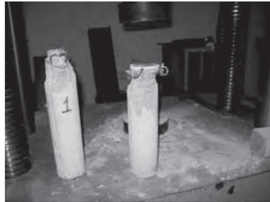
**Figura 29.** Imagen del estado definitivo de los dos especímenes circulares fallados a compresión
