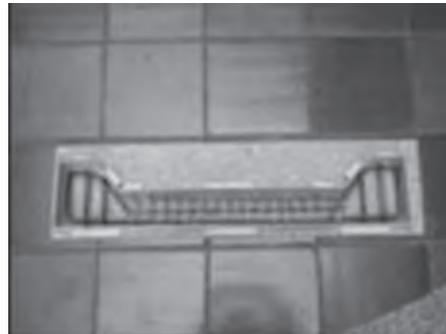
**Figura 35. Detalle de la armadura de refuerzo para el modelo de la falla a flexión**
