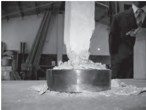
**Figura 28.** Imagen de la falla. A diferencia de la imagen mostrada en la figura 27, ésta ocurre en la base debido a sutiles defectos en el armado del refuerzo transversal en dicha zona
