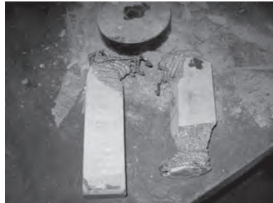
**Figura 30.** Imagen del estado definitivo de los dos especímenes rectangulares fallados a compresión
