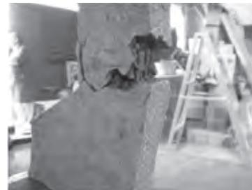
**Figuras 39, 40 y 41. Proceso de falla a flexión. Izquierda: montaje de la columna en el marco de prueba. Derecha arriba: Comienzo de la falla por flexión. Derecha abajo: Fractura de refuerzo longitudinal y excesiva rotación**
