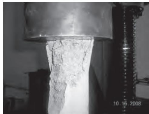
**Figuras 25 y 26. Secuencia de falla de las columnas. Izquierda: Comienzo de la pérdida del recubrimiento que no es más que el concreto confinado que sufre en primera línea de la expansión del concreto debido a la aplicación de la carga vertical. Derecha: Pérdida significativa del concreto confinado generando que el refuerzo transversal sea el encargado de resistir la expansión lateral producto del pandeo de las barras de refuerzo**
