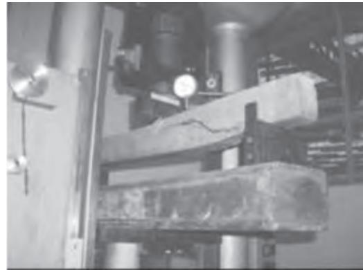
**Figuras 17 y 18. Secuencia de falla por corte de la viga. Izquierda: el estado inicial de carga. Derecha: se observa la típica fisura por corte en vigas**
