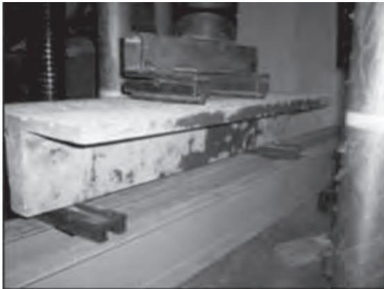
**Figura 23. Montaje de la viga para su falla**
