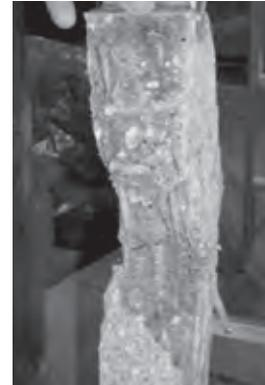
**Figuras 42, 43 y 44. Proceso de falla a compresión. Izquierda: montaje de la columna en el marco de prueba. Derecha arriba: Comienzo de la falla por flexión. Derecha abajo: Exposición total del refuerzo y falla de la columna. Se observa, como era de esperarse, la similitud en la forma de falla entre este espécimen y los especímenes de la investigación de falla por compresión axial (figuras 25 y 26)**
