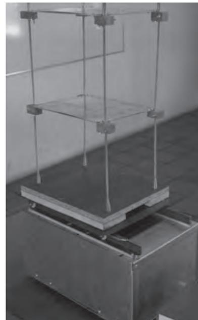
**Figura 10. Modelo en dos dimensiones apoyado en la mesa vibratoria portátil**
