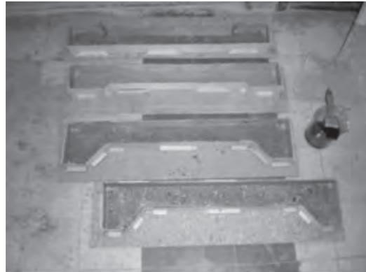
**Figura 34. Formaletas para los modelos. Las dos superiores para los modelos de falla en la zona a compresión. Las dos inferiores para los modelos de la falla en la zona a tracción**
