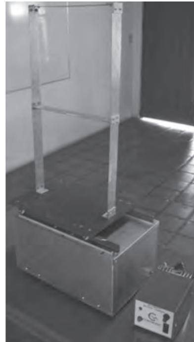
**Figura 9. Modelo en dos dimensiones apoyado en la mesa vibratoria portátil**
