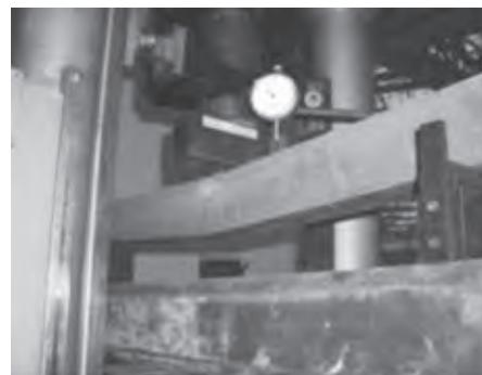
**Figuras 15 y 16. Secuencia de falla por flexión de la viga. Izquierda: el estado inicial de carga. Derecha: se observa la deflexión de la viga y cómo comienza a fisurarse**
