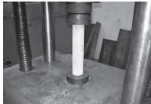
**Figura 24. Montaje de la columna en microconcreto y lista para su falla**
