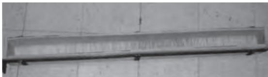
**Figura 11. Formaleta utilizada para las vigas de microconcreto**
