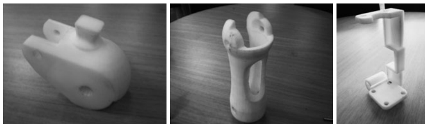
Figura 6. Partes principales de la rodilla fabricadas por prototipado rápido en material ABS
