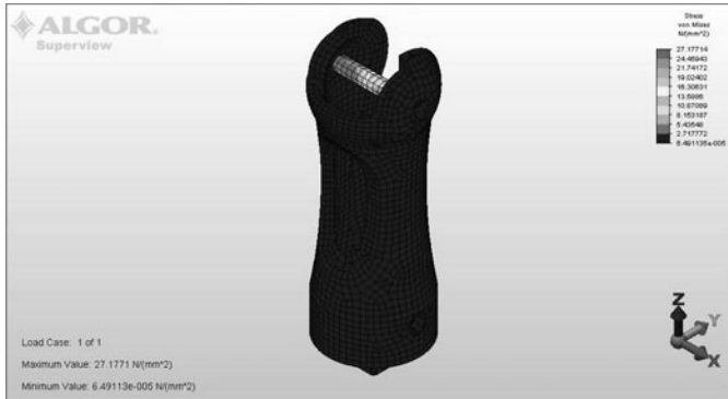
Figura 4. Simulación en software ALGOR de la pantorrilla (espesor de pared de 7 mm)
