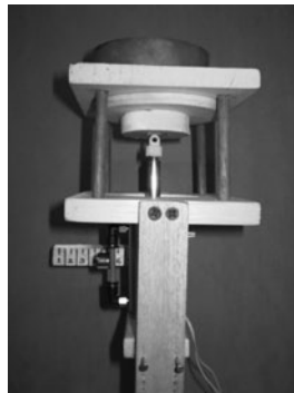
Figura 8. Pruebas de funcionamiento del amortiguador desplazando el imán desde la manguera con 1 kg de peso
