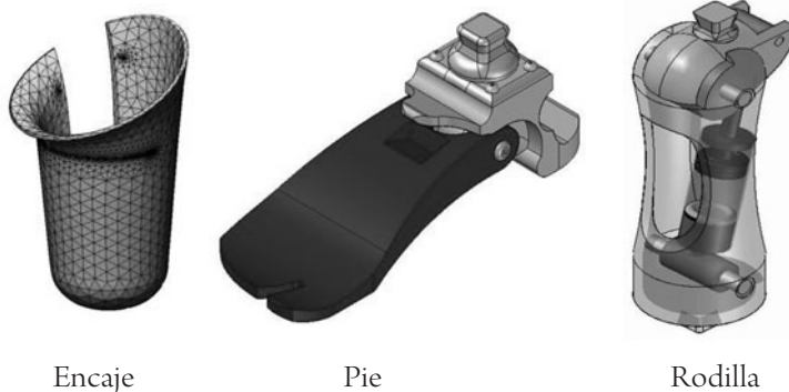
Figura 1. Partes componentes de la prótesis transfemoral, modeladas en software CAD
