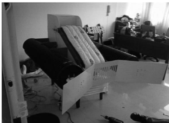
Figura 12. Ensamble de la estructura central con los flotadores
