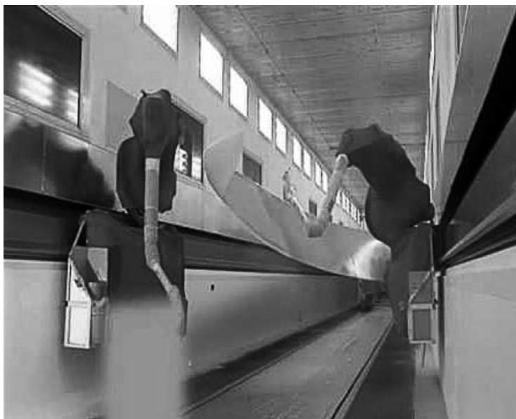
Figura 5. Aplicación de recubrimiento en una turbina
