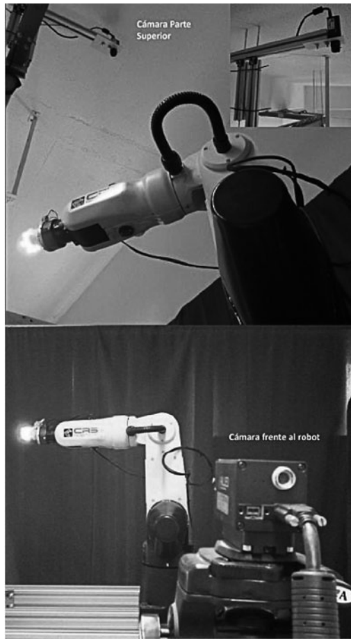
Figura 7. Robot A465 de CRS Robotics con sistema de visión en 3D
