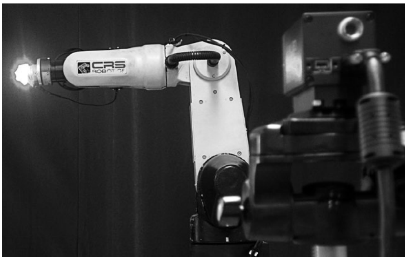
Figura 6. Robot A465 de CRS Robotics con sistema de visión en 2D
