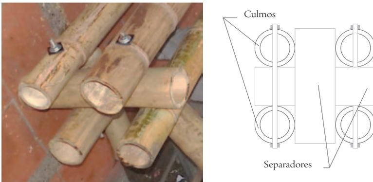
Figura 2. Sección transversal de la columna
