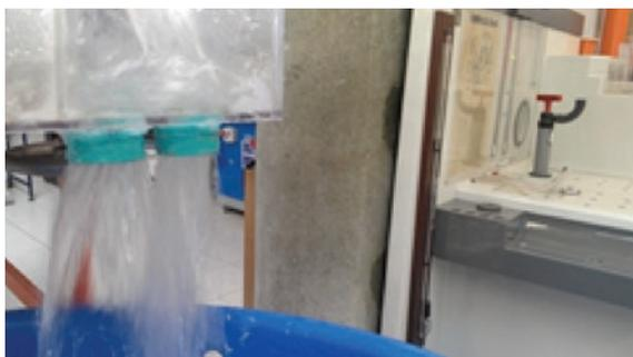
Figura 8. Sistema de aforo cuneta
