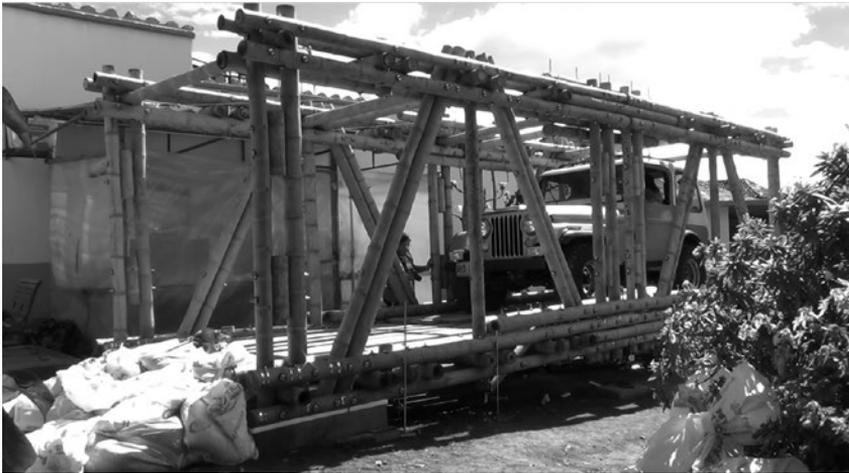
Figura 12. Prueba de carga con un vehículo liviano, peso aproximado 18 kN
