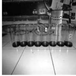
Botellas con muestra de asfalto modificado, antes de la prueba. Botella I y II. Para pérdida de masa.
