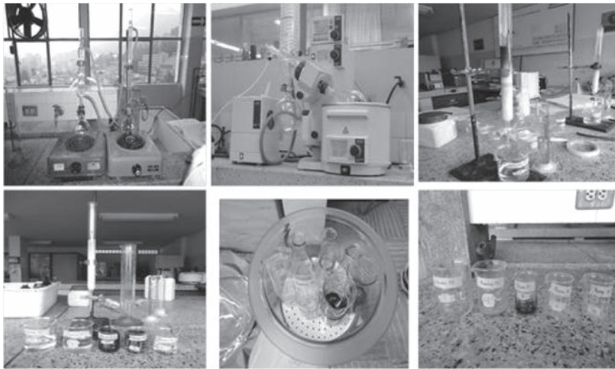
Figura 5. Separación del asfalto en sus cuatro fracciones: saturados, aromáticos, resinas, asfáltenos (SARA)
