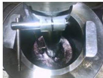
Proceso de modificación de asfalto 80-100
