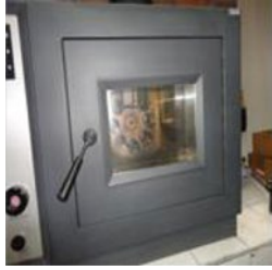
Botellas girando a temperatura 163°C, durante 85 min. Asfalto Sin Modificar
