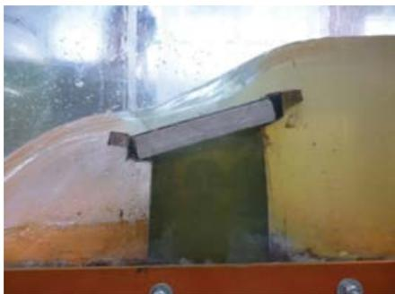
Figura 3. Vista lateral del canal de aducción. Se observa la inclinación de la rejilla
