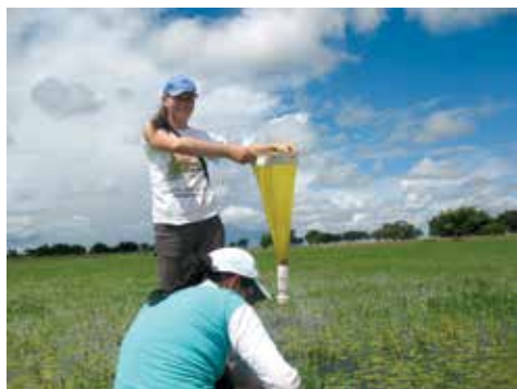
Figura 3. Redes cónicas de nylon para fitoplancton (izquierda) y zooplancton (derecha) con las que se filtraron 20 L de agua de superficie
