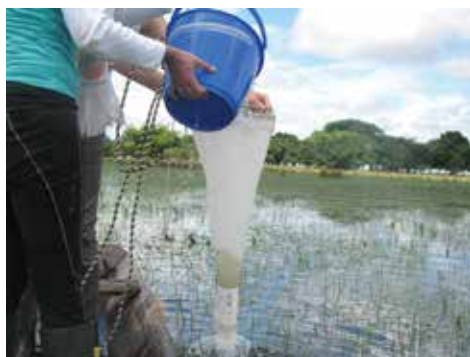
Figura 3. Redes cónicas de nylon para fitoplancton (izquierda) y zooplancton (derecha) con las que se filtraron 20 L de agua de superficie
